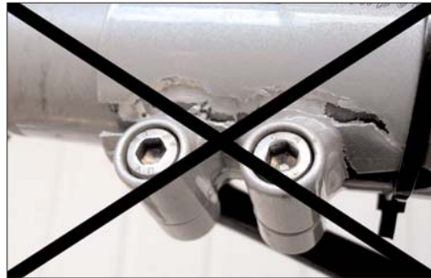
Wenn die Distanzbuchse fehlt, verdreht ist oder verschoben ist oder die Schrauben zu fest angezogen werden, kann der Rahmen beschädigt werden!
