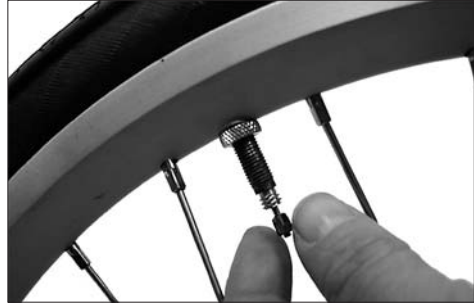
Zum Aufpumpen muss die Sicherungsmutter des Ventils nach oben geschraubt werden.
