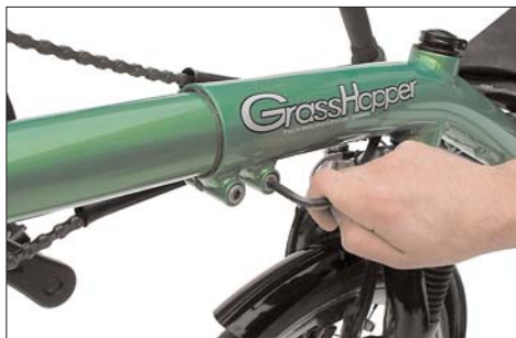
Lösen der Klemmschrauben zum Verstellen des Tretlagerauslegers.
