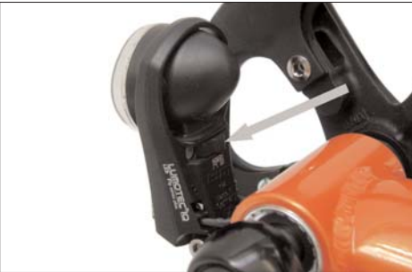
Die Beleuchtung mit Nabendynamo wird mit dem Schalter am Scheinwerfer eingeschaltet.
