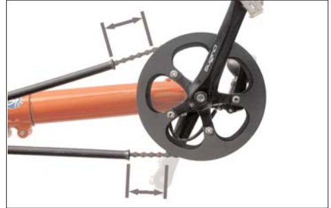
Zwischen den Enden der Kettenschutzrohre und den Schaltwerksteilen müssen bei gespannter Kette mindestens 5 cm Abstand verbleiben.
