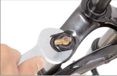
Nach dem Entspannen der Feder-Vorspannungseinheit kann die ganze Einheit herausgedreht werden.
