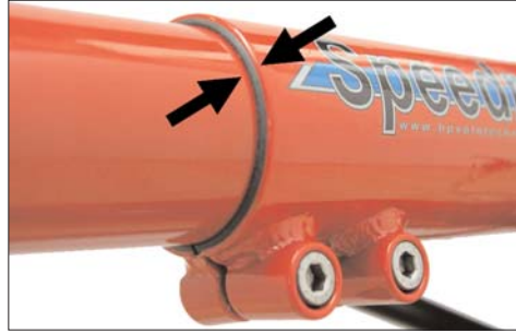
Zwischen Hauptrahmen und Tretlagerausleger muss die Distanzbuchse von vorne sichtbar sein.
