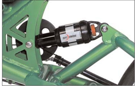
Federelement DT-Swiss XM180. Die Einstellung der Dämpfung erfolgt über das rote Rad am hinteren Ende.
